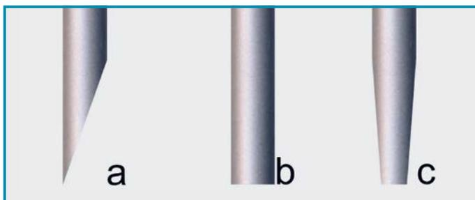
Las agujas tipo "A" están diseñadas para una penetración óptima con bisel de 17°. También minimiza la fuerza de perforación necesaria y el diámetro del canal de inyección.
