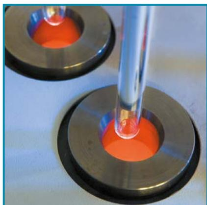
Los tubos de vidrio se calientan lenta y gradualmente hasta un nivel medio de fusión. Luego se encogen alrededor de las varillas de acero con un diámetro preciso.
