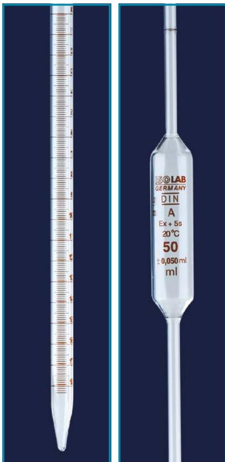
➤ Fabricado con tubos neutros según las normas ISO 648 y DIN 12687, ISO 835 y DIN 12699.
