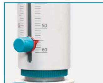
Ajuste de volumen rápido, fácil y fiable con botón de ajuste de volumen que gira 180°.
