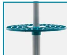
El disco superior con dibujo de rejilla, que es concéntrico con la placa de soporte, mantiene las pipetas en posición vertical y correcta.
