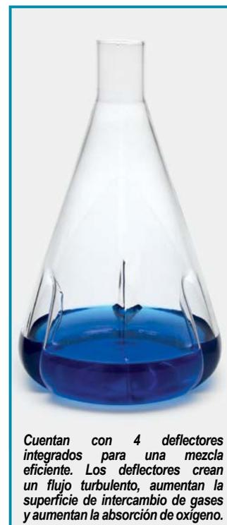
Cuentan con 4 deflectores integrados para una mezcla eficiente. Los deflectores crean un flujo turbulento, aumentan la superficie de intercambio de gases y aumentan la absorción de oxígeno.
