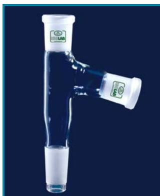
➤ Fabricado en vidrio de borosilicato resistente al calor y duradero, provisto con un conector hembra con curva de 75° hacia abajo.
