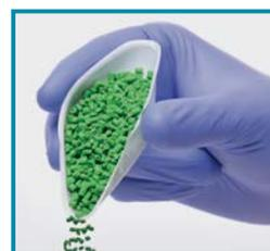
Con una ligera presión a los lados, los platos de pesaje se pueden convertir fácilmente en un embudo de vertido para una transferencia de muestras fácil y sin derrames.
