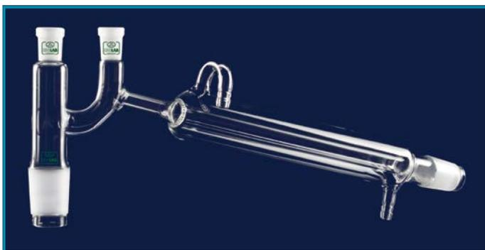
► Fabricado en vidrio de borosilicato resistente al calor y duradero, con un condensador liebig, con dos conectores hembra NS 14/23, diseñado para ser usado con termómetros de destilación.
