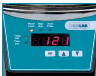
Cuenta con un temporizador electrónico de pantalla LED que permite el control del tiempo entre 1 y 99 minutos.
