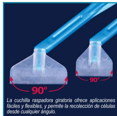
La cuchilla raspadora giratoria ofrece aplicaciones fáciles y flexibles, y permite la recolección de células desde cualquier ángulo.
