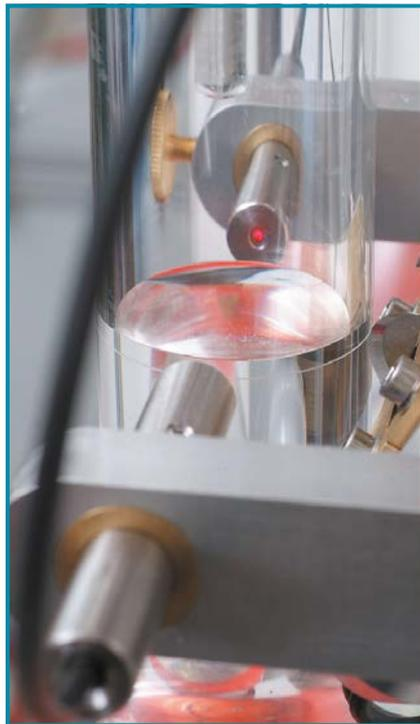
El menisco se determina de forma automática y exacta en su nivel más bajo mediante un rayo láser.
