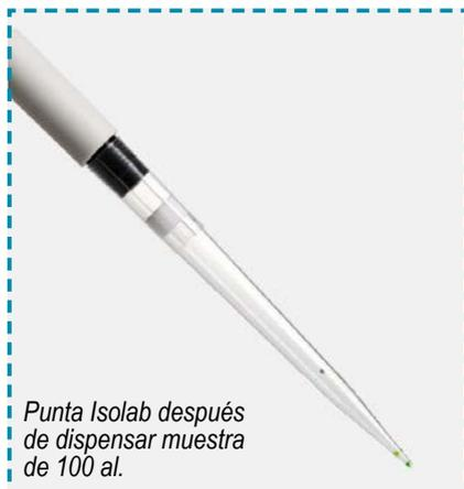
Punta Isolab después de dispensar muestra de 100 µl.
