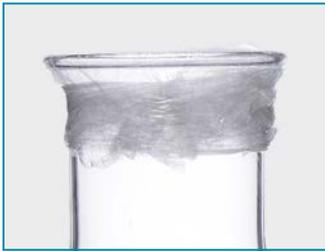
*Ofrece característica de estiramiento y adhesión extremadamente buenas. Herramienta perfecta para el sellado y envoltura de distintos materiales de laboratorio.*
