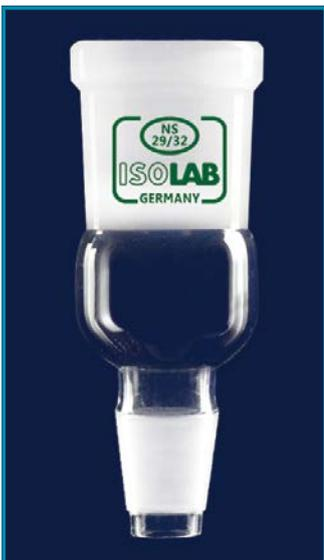
► Fabricado en vidrio de borosilicato resistente al calor y duradero según la norma ISO 12257. con conector hembra de tamaño mayor que el tamaño del cono.
