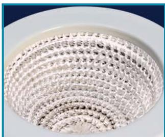
El elemento calefactor está hecho de una fibra de vidrio resistente al calor altamente flexible que funciona a una temperatura máxima de 900°C.
