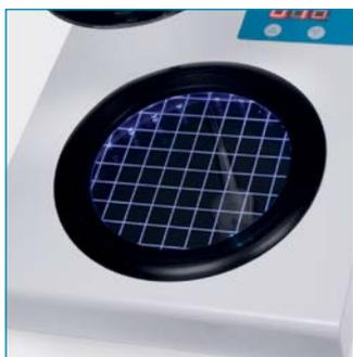
El sistema de iluminación circular con LED permite una iluminación sin sombras, ni parpadeos, ni desarrollo de calor, con una concentración de luz óptima.
