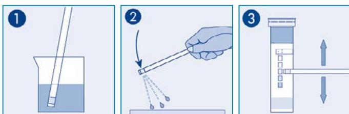
1 Sumerja la tira de prueba en la muestra hasta la flecha durante un segundo. 2 Sacuda el exceso de líquido y coloque la tira sobre una superficie horizontal. 3 Lea el resultado comparando el campo de prueba con la escala de colores.
